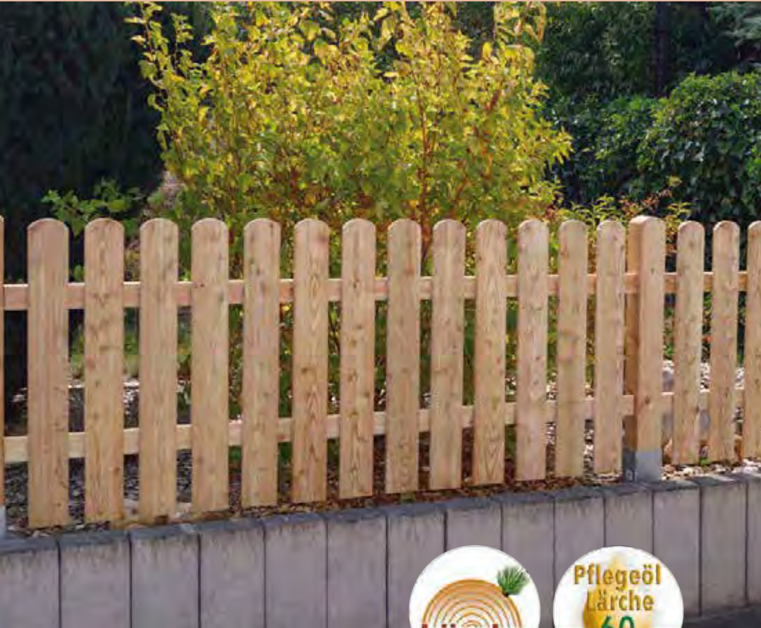
Staketenzaun Föhr aus Lärche Bretter 2,0 x 9,5 cm gehobelt, verzinkt genagelt, Kanten gefast, Kopf gerundet
