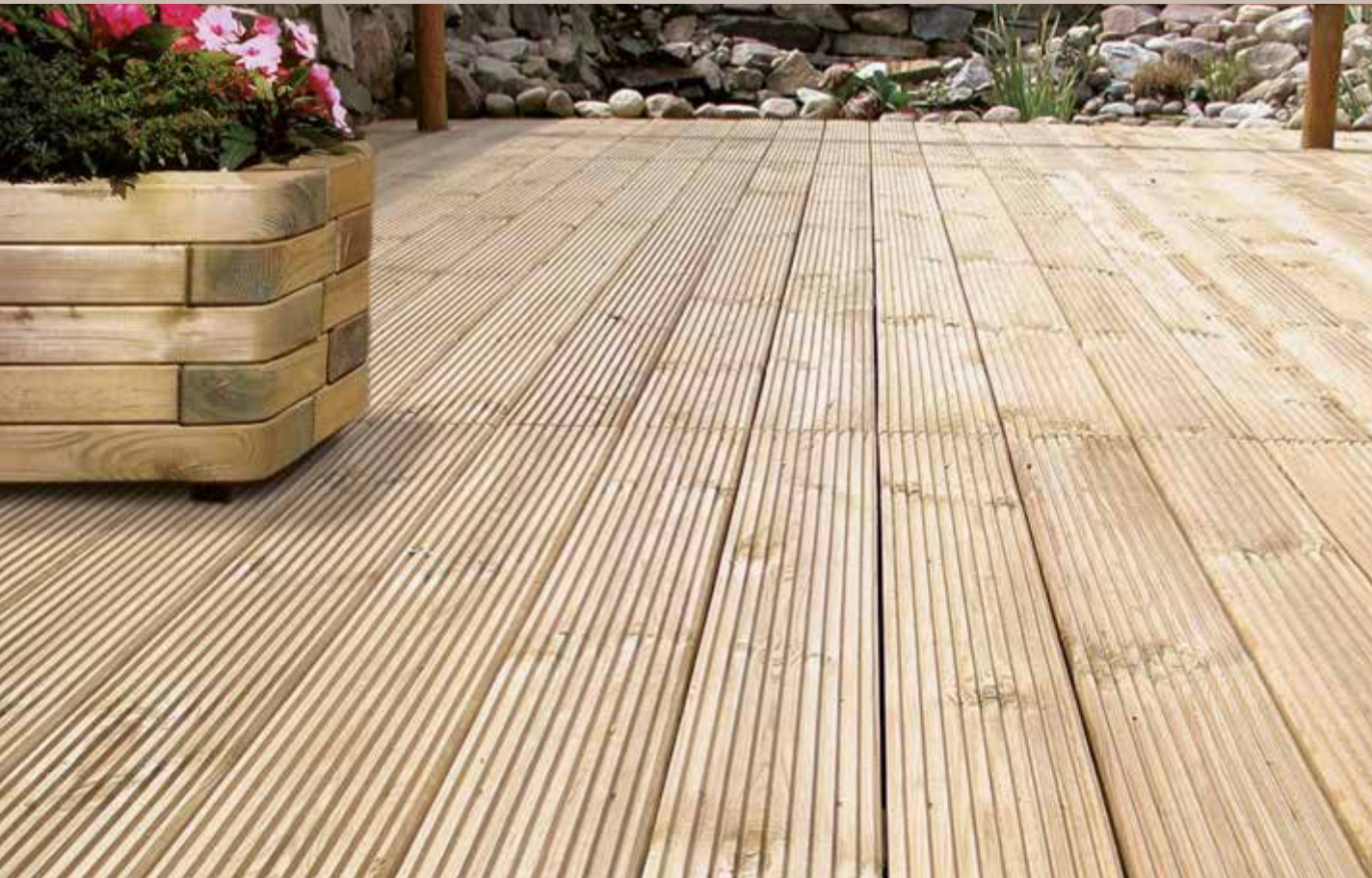
Kombi-Bodendiele aus Fichte 2,7 cm stark, 14,6 cm breit, kesseldruckimprägniert, beide Breitseiten unterschiedlich geriffelt.
