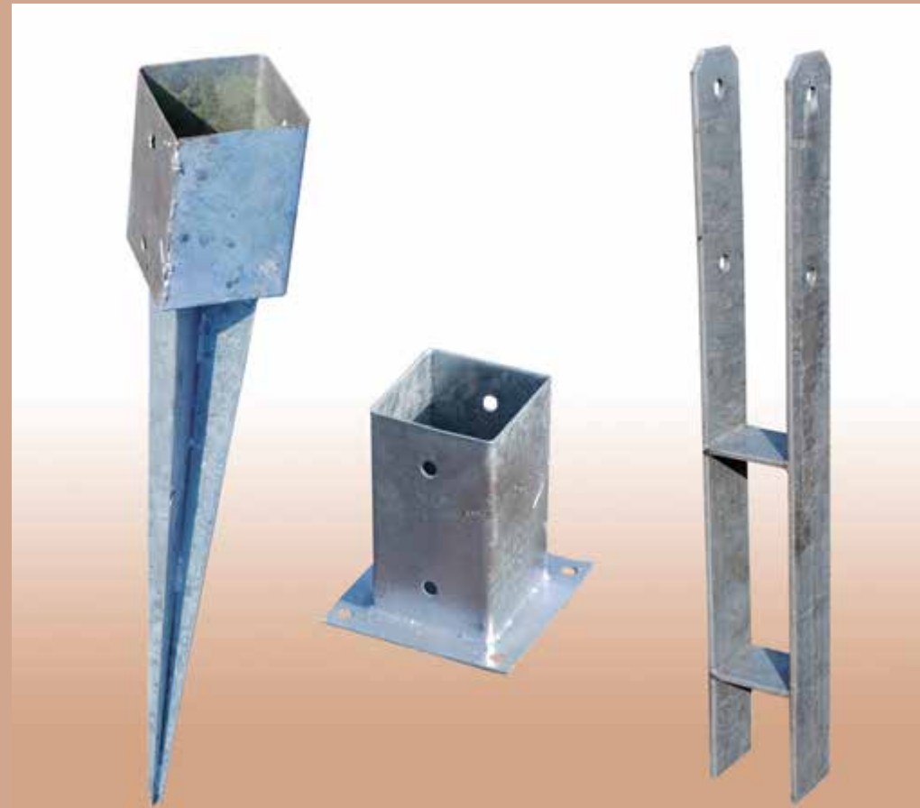
Einschlagbodenhülse Aufschraubodenhülse, Stahl, verzinkt, für Pfosten 7 x 7 cm bzw. 9 x 9 cm
